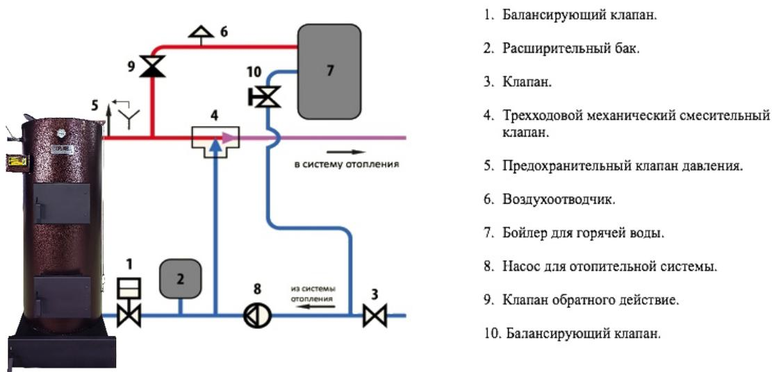
**Рис.5 Рекомендуемая схема (бойлер параллельно) с термостатическим трехходовым клапаном**
