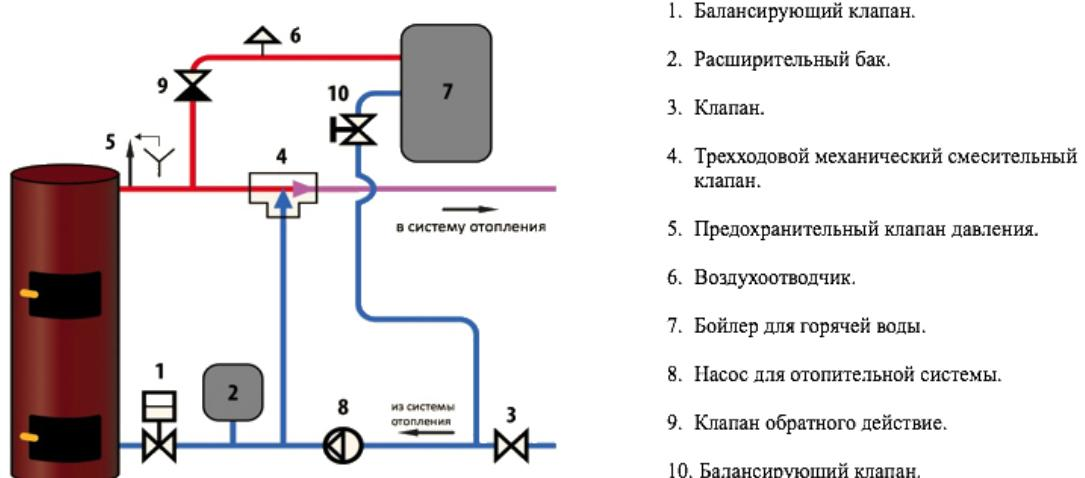
**Рис.5 Рекомендуемая схема (бойлер паралельно) с терmostатическим трехходовым клапаном**
