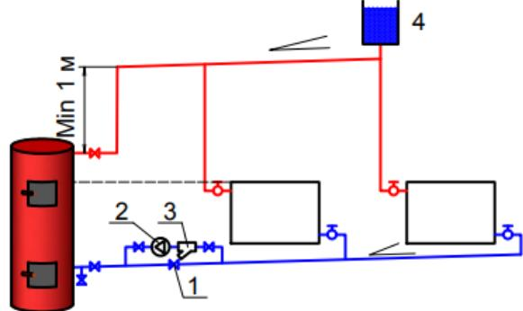
**Рис. 8. Система с установкой гидросмесительного узла**
